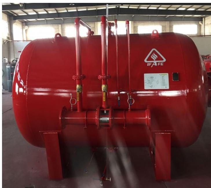
普通泡沫罐在使用时，带有泡沫液液位计的泡沫罐首先要关闭液位计阀，开启主管道阀门，从主管道开始进水，当供水压力达到所需压力时，打开进水阀，观看压力表，当罐中压力达到比例混合器工作压力范围时，打开出液阀，这样混合液就能按照设置好的比例输出泡沫混合液进行灭火。2、消防泡沫罐灭火工作后，将进水阀和出液阀关闭，打开排气阀泄压，当压力表复零时，打开排液阀，把罐内剩余液体排尽，并关闭排气阀、排液阀。3、由于无隔膜泡沫罐在使用时，泡沫液全部与水混合，剩余的泡沫液不能再二次使用，因此，每次使用或者检验使用后，剩余泡沫液要全部放出，对泡沫罐进行彻底的清洗，重新充装泡沫液。德焱消防引进先进的生产设备和独特的制作工艺。日照消防泡沫罐多少钱
