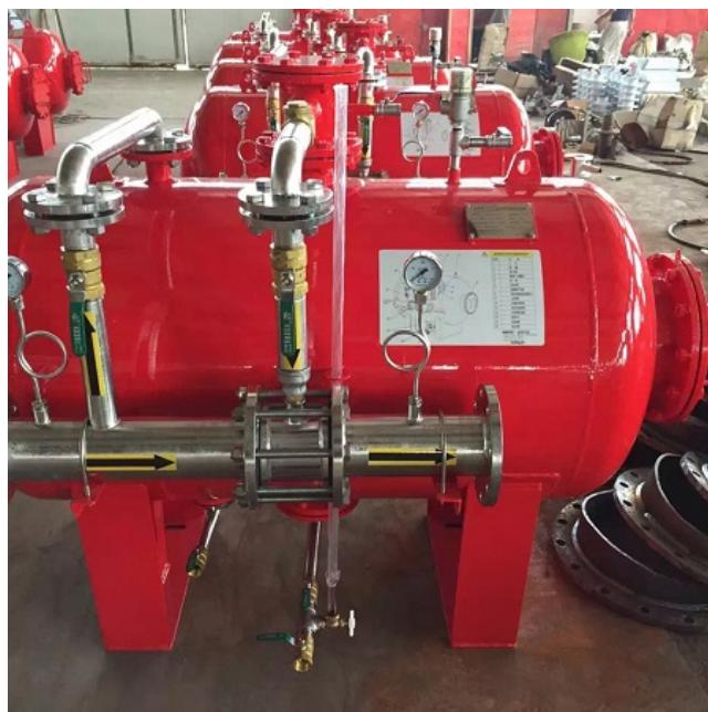
当消防水泵的压力水沿供水管道进入比例混合器时，一小部分压力经进水管道流入泡沫液贮
