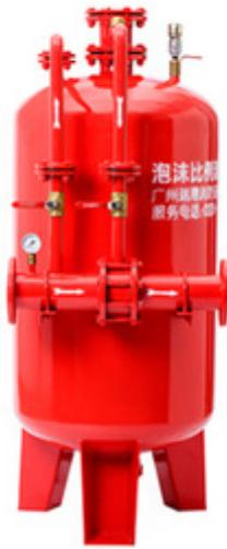
压力式泡沫份额混杂设置装备摆设主要由带胶囊的泡沫液压力储罐与应用文丘里道理制成的PHY型压力式份额混合器构成，当系统管网中的水流经份额混合器减压孔板时，在孔板的前后会构成压差。将一部分水&lt;垃圾和GT;或6&lt;垃圾和GT;-rrbi-通过火泡泡罐的进水口压入容器，揉捏容器，容器中的泡沫液体在低压下通过火泡沫罐的液体生产管揉合到搅拌器的一部分，并与水混合，形成泡沫混合物，成型的泡沫混合物出口到泡沫发生器（中，低，高泡沫发生器，泡沫，泡沫，等）与空气泡沫混合，通过“进水阀”管道将部分水放入水箱的水腔中，揉碎胶囊，因为喷嘴的前后压力差不大，使胶囊中的泡沫液体通过吸管挤出。与水混合成泡沫混合的液体流动，泡沫被空气泡沫发生器或其他喷发设备喷出以挽救生命。水箱里有一个橡胶容器，它把水和泡沫液分开。每次使用后，水箱中的水和泡沫液不能混合，以保持原有泡沫液体的功能不变，可持续使用，避免了泡沫液体的浪费。
